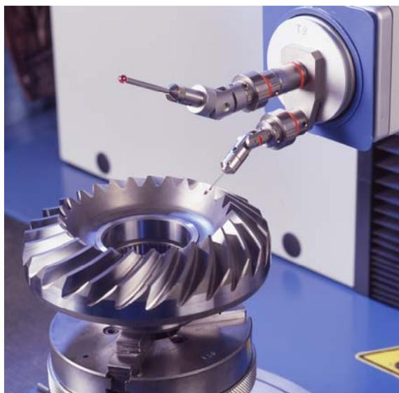
Bild: Dieter Demme: Kegelradantriebsteil im Test.
